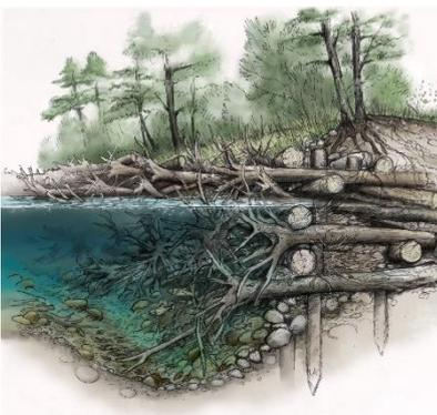
Abbildung 19: Beispiel naturnahe Flussufersicherung, Bildquelle: Emch+Berger
