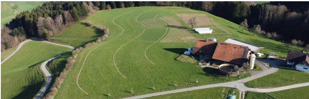
Abbildung 23: Neu angelegte Key-lines am Katzhof in Reiden: Die nur mit leichtem Gefälle entlang der Höhenlinien ausgehobenen Gräben verteilen Regenwasser kontrolliert auf dem ganzen Feld und ermöglichen eine effiziente Versickerung. Überschüssiges Wasser sammelt sich in Becken und Teichen, von wo es bei Bedarf wiederum zur Bewässerung eingesetzt werden kann. Planung & Bildquelle: P. Gehrhardt / [baumfeldwirtschaft](#)
